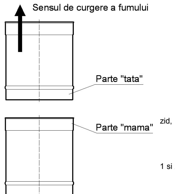
Elementele se imbina si rigidizeaza unele cu celelalte cu ajutorul colierelor tip N atasate fiecarui element in parte.
